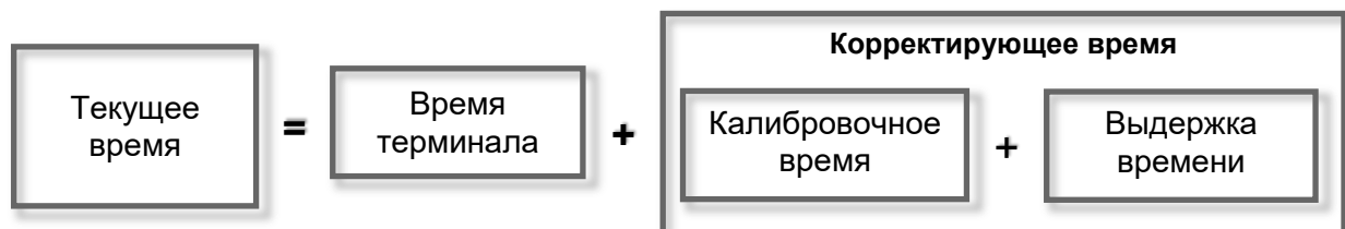
Рисунок 46 – Текущее время терминала (импульсная синхронизация PPS)
